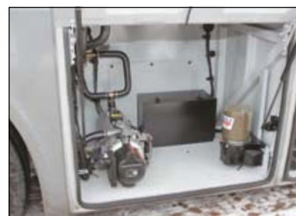
В боковом отсеке – автономный отопитель салона, насос, блок управления системы централизованной смазки, ЗИП.
