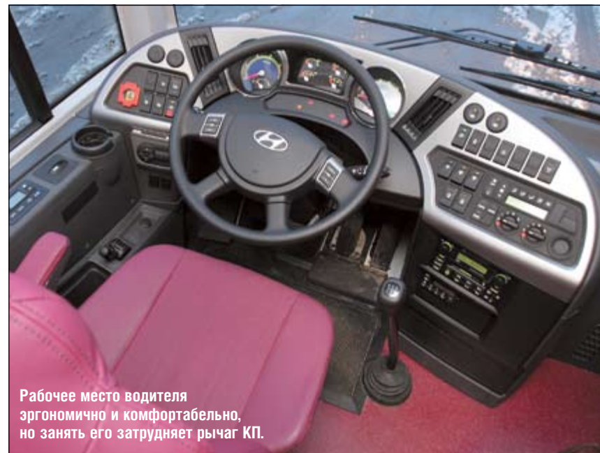
Щиток приборов красивый и информативный. Вместо дисплея бортового компьютера – привычные указатели.
