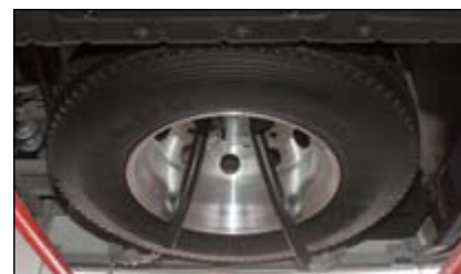
Запасное колесо – под передним бампером. Для удобства его установки желательны специальные салазки.
