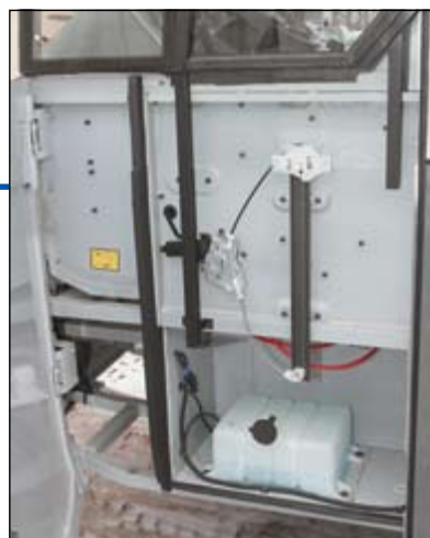
В передней части автобуса, слева – сервисная панель с откидной крышкой, облегчающая техобслуживание.
