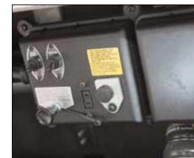
Хороший доступ в моторный отсек обеспечивают большой задний люк и боковые крышки. Установлен блокиратор, недопускающий запуск двигателя из кабины во время обслуживания.
