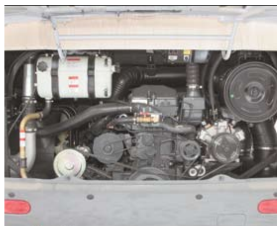
Хороший доступ в моторный отсек обеспечивают большой задний люк и боковые крышки. Установлен блокиратор, недопускающий запуск двигателя из кабины во время обслуживания.
