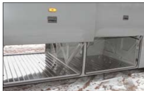
Сквозной багажник имеет емкость 6 м куб. Пол из оцинкованного металла, что практично, но его неплохо было усилить.
