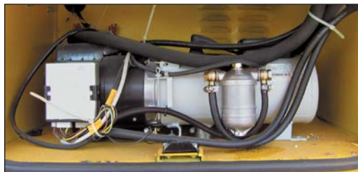
«Автономка» в салоне, она же предпусковой подогреватель двигателя – и морозов можно не бояться.
