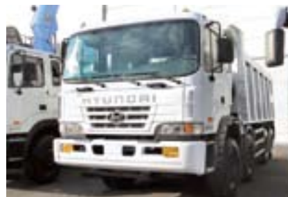
Мощный строительный самосвал Hyundai HD370 (8x4) имеет платформу на 25 м куб.
